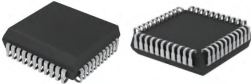
Görsel 7.18: PLCC kılıf yapısında entegre
