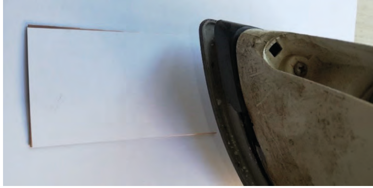
Görsel 6.4: Ütüleme işlemiyle görüntünün bakır plakete aktarılması
