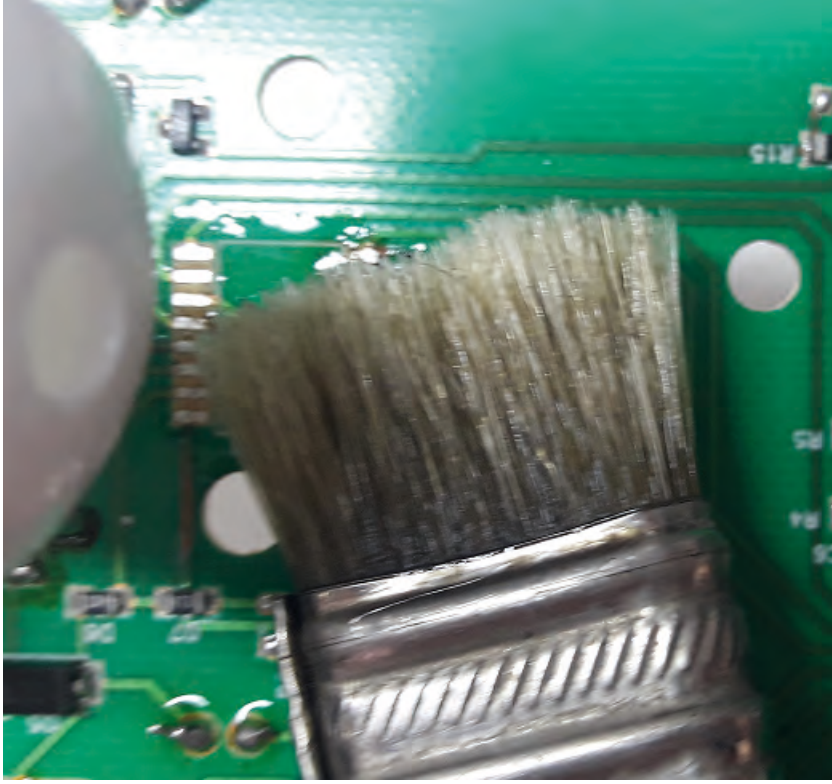
Görsel 7.26: Baskı devre kartının temizlenmesi
