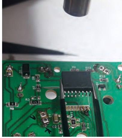
Görsel 7.24: SMD entegrenin antistatik cımbız ile yerinden alınması
