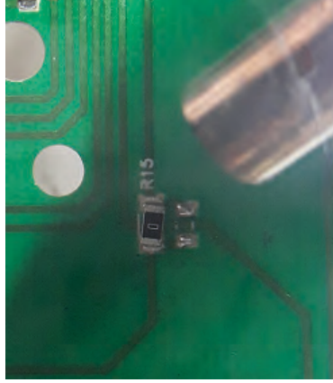
Görsel 7.13: SMD elemanın üstten ısıtılması
