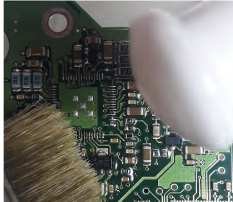
Görsel 7.40: Baskı devre kartının temizlenmesi
