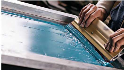
Görsel 5.20: Ragle ile ipek üzerinden boya çekilmesi
