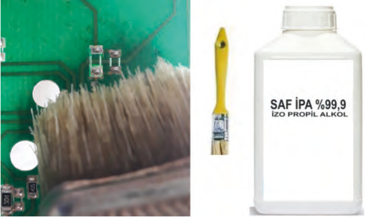
Görsel 7.8: Baskı devre kartının temizlenmesi
