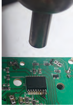
Görsel 7.23: SMD entegrenin üstten ısıtılması
