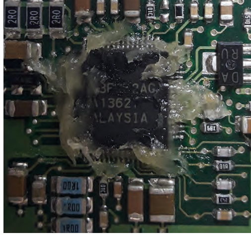
Görsel 7.36: Çipset üzerine flux sürülmesi
