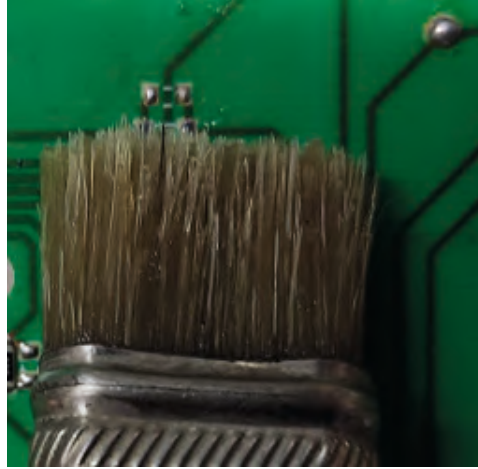
Görsel 7.10: SMD eleman bağlantı noktasının temizlenmesi
