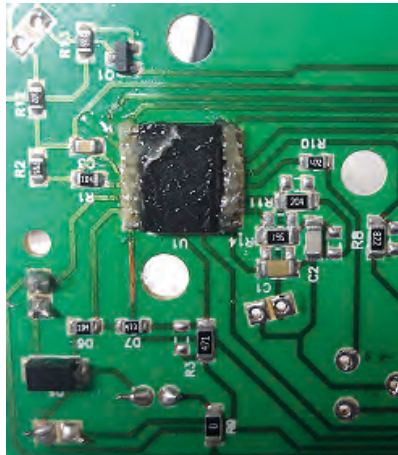
Görsel 7.22: SMD entegre üzerine flux sürülmesi
