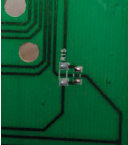
Görsel 7.11: SMD elemanın bağlantı noktasına krem lehim sürülmesi
