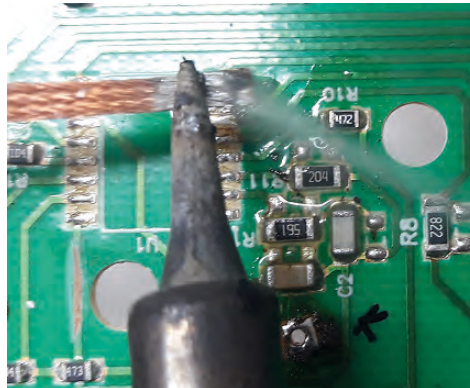
Görsel 7.25: Lehimin lehim fitili ile temizlenmesi
