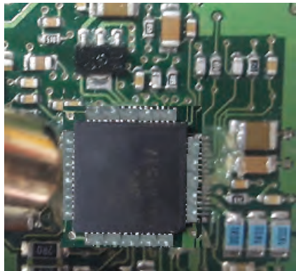
Görsel 7.44: Çipsetin üstten ısıtılması
