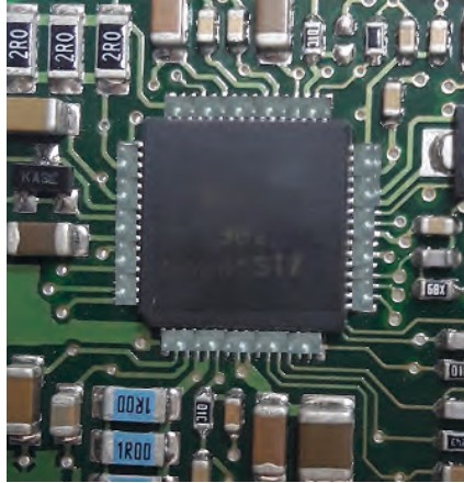
Görsel 7.43: Çipsetin bağlantı noktalarına krem lehim sürülmesi
