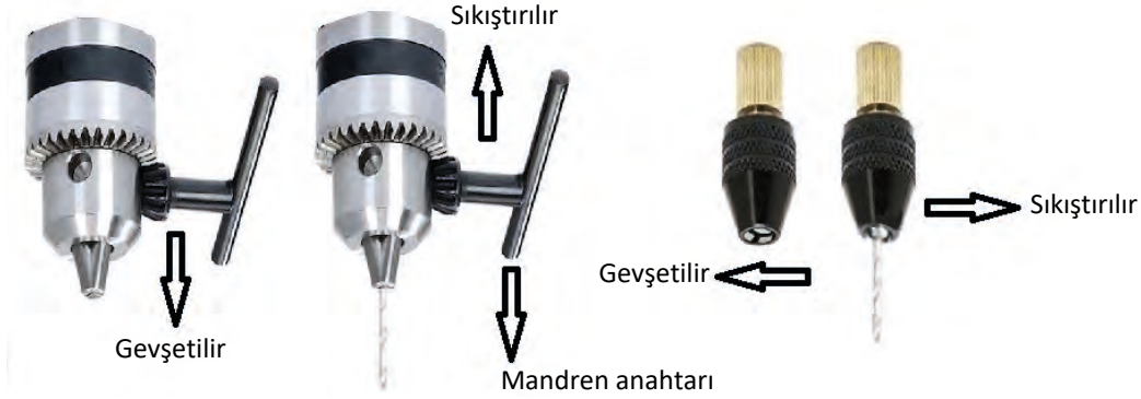
Görsel 5.28: Mandrene matkap ucunun yerleştirilmesi
