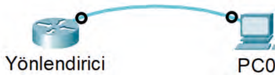
Görsel 3.3: Yönlendiricinin konsol kablosu ile bağlantısı
