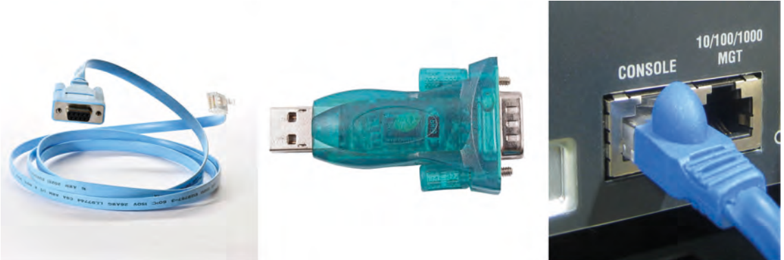
Görsel 3.1: Konsol kablosu ve dönüştürücü
