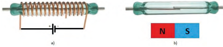
Görsel 3.35: a) Çubuk röle bobin bağlantısı
