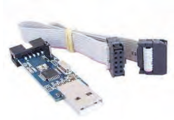
Görsel 2.82: Denetleyici programcısı
