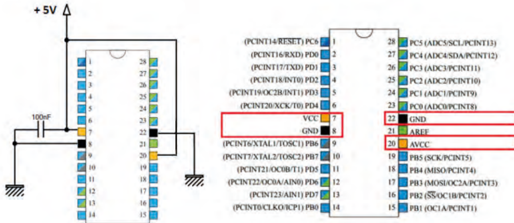
Görsel 2.16: Atmega328P besleme uçları ve bağlantıları
