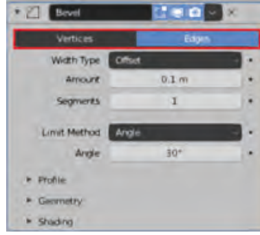
Görsel 3.103: Bevel değiştiricisi köşe parametreleri
