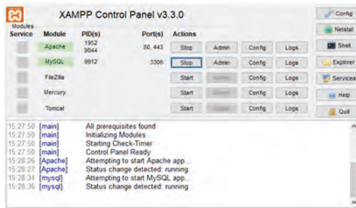
Görsel 2.3: Local Web Server programının control paneli
