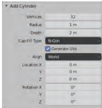
Görsel 3.24: Silindirik nesnesine ait parametrelerin girilmesi
